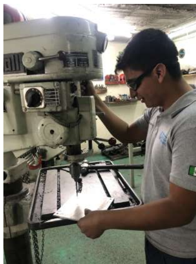
Figura 8: Barrenado de Placa Superior
