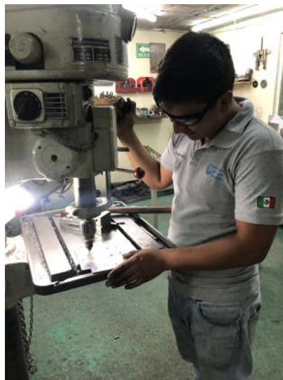
Figura 6: Barrenado para Fijación de Placa Inferior
