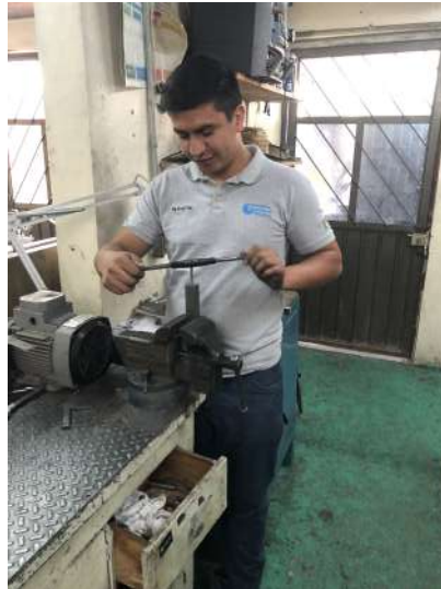
Figura 7: Machueleado para Tornillos
