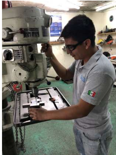
Figura 5: Barrenado de Eje
