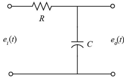
Simule la respuesta del sistema  $G(s) = \frac{E_o(s)}{E_i(s)}$  introduciendo una señal de escalón de 5.0V en  $e_i(t)$  de acuerdo al siguiente circuito:
