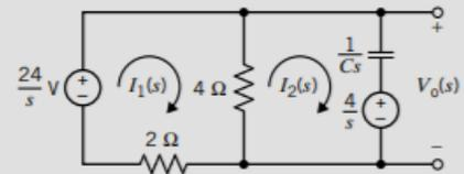
FIGURA 14.7-6 El circuito, representado en el dominio de frecuencia, utilizando la transformada de Laplace.
